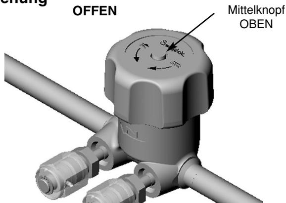
Zum Öffnen des Ventils Handrad zweieinhalb Drehungen *entgegen dem Uhrzeigersinn* drehen.
