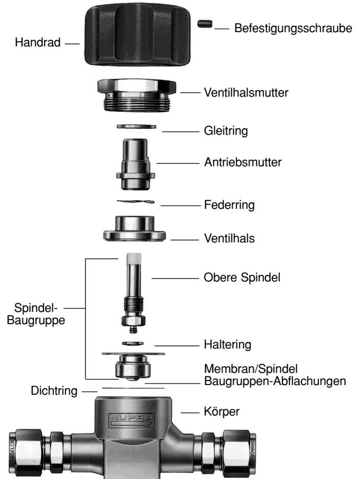
12. **Ventilhalsmutter** in den Körper schrauben und mit einem Drehmoment von  $62,2 \text{ N} \cdot \text{m}$  ( $634 \text{ cm} \cdot \text{kg}$ ) ( $550 \text{ in.} \cdot \text{lb}$ ) festziehen.
