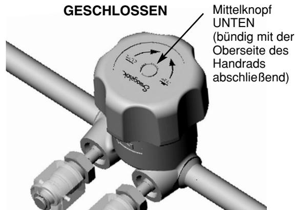
Zum Schließen des Ventils Handrad zweieinhalb Drehungen *im Uhrzeigersinn* drehen.
