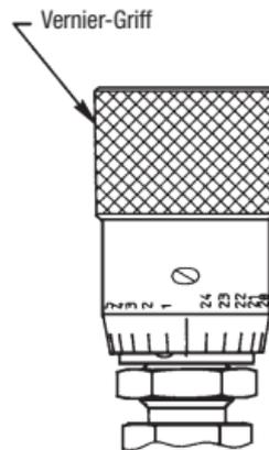
**SCHRITT 5** Stecken Sie den **Mikrometerkopf** auf die **Schaftverlängerung** und richten Sie die Null-Markierung auf dem **Griff** auf die Null-Markierung auf der **Walze** aus. Ziehen Sie die **Griffschraube** **fest**. Ventil auf richtigen Betrieb überprüfen.
