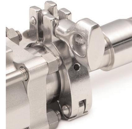
4. Klammer anbringen und Flügelschraube festziehen, bis eine Metall-Metall-Verbindung hergestellt ist. Um das korrekte Festziehen der PTFE-Dichtungen oder der Adapterdichtungen zu erleichtern, kann ein Swagelok-Werkzeug zum Festziehen von Flügelschrauben verwendet werden.
