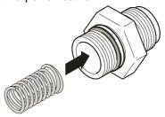
6. Schließelement auf die Feder setzen.
