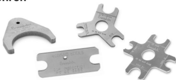
Swagelok Prüflehren bestätigen dem Monteur oder Kontrolleur, dass die Rohrverschraubung sicher bei der Erstmontage montiert wurde, unabhängig davon, ob ein mehrköpfiges, hydraulisches Vormontagewerkzeug (MHSU) oder ein pneumatisch betätigtes, hydraulisches Vormontagewerkzeug (AHSU) bzw. ein Schraubenschlüssel zum Anziehen verwendet wurde. Alle Swagelok Rohrverschraubungen aus Metall sind prüflehrenfähig außer einigen geschmiedeten Aluminiumkörpern.
