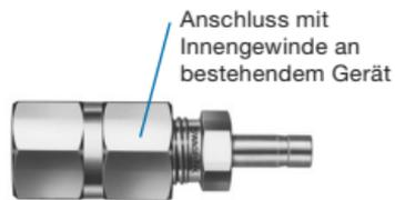
2. Den Rohrstutzen in die Swagelok Rohrverschraubung einsetzen. Sicherstellen, dass der Rohrstutzen fest auf der Schulter des Rohrverschraubungskörpers aufsitzt und die Überwurfmutter fingerfest angezogen ist.
