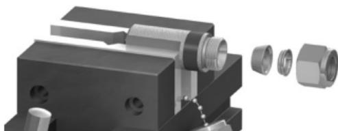
2. Sicherstellen, dass das Rohr fest auf der Schulter des Vormontagewerkzeugkörpers aufsitzt; die Überwurfmutter fingerfest anziehen.
