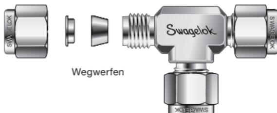
2. Die Überwurfmutter über die Rohrstückseite mit dem angedrehten Klemmring schieben.
