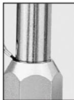
2. Das Rohr aus dem DMT nehmen und in die Swagelok Rohrverschraubung einstecken, bis es im Verschraubungskörper aufsitzt. Die Überwurfmutter fingerfest anziehen. Sollte ein Teil der Markierung oberhalb der Überwurfmutter zu sehen sein, sitzt das Rohr nicht ganz in der Rohrverschraubung auf.
