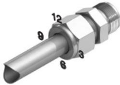
3. Den Verschraubungskörper festhalten und die Überwurfmutter mit einer halben Umdrehung auf die 12-Uhr-Position anziehen.
