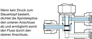
Wenn kein Druck zum Steuerkopf besteht, dichtet die Spindelspitze den unteren Anschluss ab und ermöglicht somit den Fluss durch den
