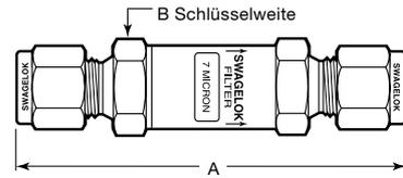
Die Abmessungen sind mit fingerfest angezogenen Swagelok Überwurfmuttern.
